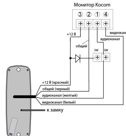
Для многоканальных мониторов типа DPV-4MT, QM-4MT, KW-4MT и других при подключении дополнительных видеокамер может не работать выбор каналов (на дополнительную видеокамеру монитор переключаться не будет).
