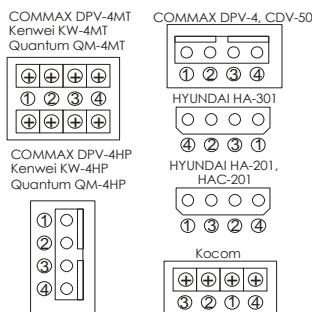
**Примечание:** У мониторов, имеющих разъем для подключения видеопамяти (DPV-4HP, QM-4HP, KW-4HP, HA-200 и другие) при отсутствии видеопамяти на данном разъеме ставится перемычка. Иногда данная перемычка не ставится в разъем на предприятии-изготовителе, а поставляется в отдельном пакетике. **Без правильно установленной перемычки данные мониторы не будут показывать изображение с видеокамеры панели!**
