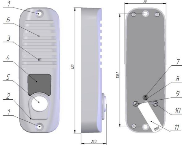
**1**- Места крепления панели (закрываются заглушками). **2**- Зона микрофона со скрытой прорезью. **3**- Видеокамера. **4**- ИК защитное стекло. **5**- Кнопка вызова. **6**- Зона динамика со скрытыми прорезями. **7**- 4-х жильный провод подключения к монитору. **8**- 2-х жильный провод подключения к замку. **9** – регулировка громкости динамика панели, **10** – регулировка баланса, **11**- Гарантийная пломба.
